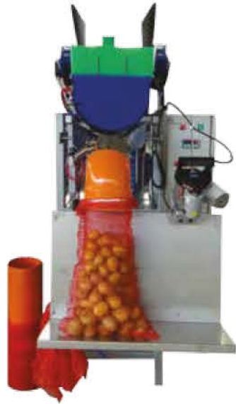
ОБОРУДОВАНИЕ ДЛЯ ВЗВЕШИВАНИЯ И УПАКОВКИ Упаковка в сетчатый материал весом от 10 кг до 25 кг
