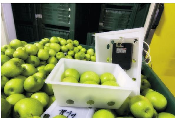
Компания Isolcell всегда в авангарде развития технологий хранения, и в 2003 году совершила революцию в технологии длительного хранения овощей и фруктов: разработала систему с динамической регуляцией газовой среды с использованием датчиков флюоресценции HarvestWatch®. Это единственная на рынке технология, которая снижает уровень кислорода до минимума, что позволяет значительно повысить качество хранения без риска ферментации продуктов.
