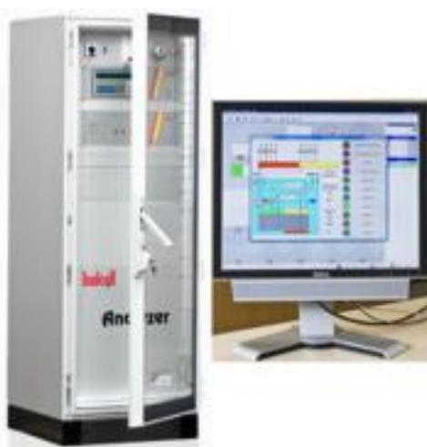
разработан специально для анализа кислорода и углекислого газа в помещениях контролируемой атмосферы. Элегантные, лакированные корпуса шкафов следующих устройств:
