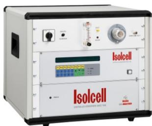
**SELECA** — это централизованный анализатор CO<sub>2</sub> и O<sub>2</sub>, предназначенный для мониторинга небольшого числа камер. Он оборудован микропроцессором, обеспечивающим автоматическое функционирование объекта с РГС. Основной блок может контролировать до 8 камер, а модульное исполнение предусматривает возможность расширения. Для замеров уровня кислорода в анализаторе используется электрохимическая ячейка, а для измерения уровня
