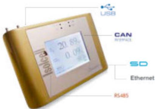
**OXYCARB 6** — это портативный анализатор кислорода и углекислого газа. В **OXYCARB 6** используются новейшие энергоэффективные датчики с температурной компенсацией: электрохимические для определения кислорода и инфракрасные — для углекислого газа. Конструкция **OXYCARB**
